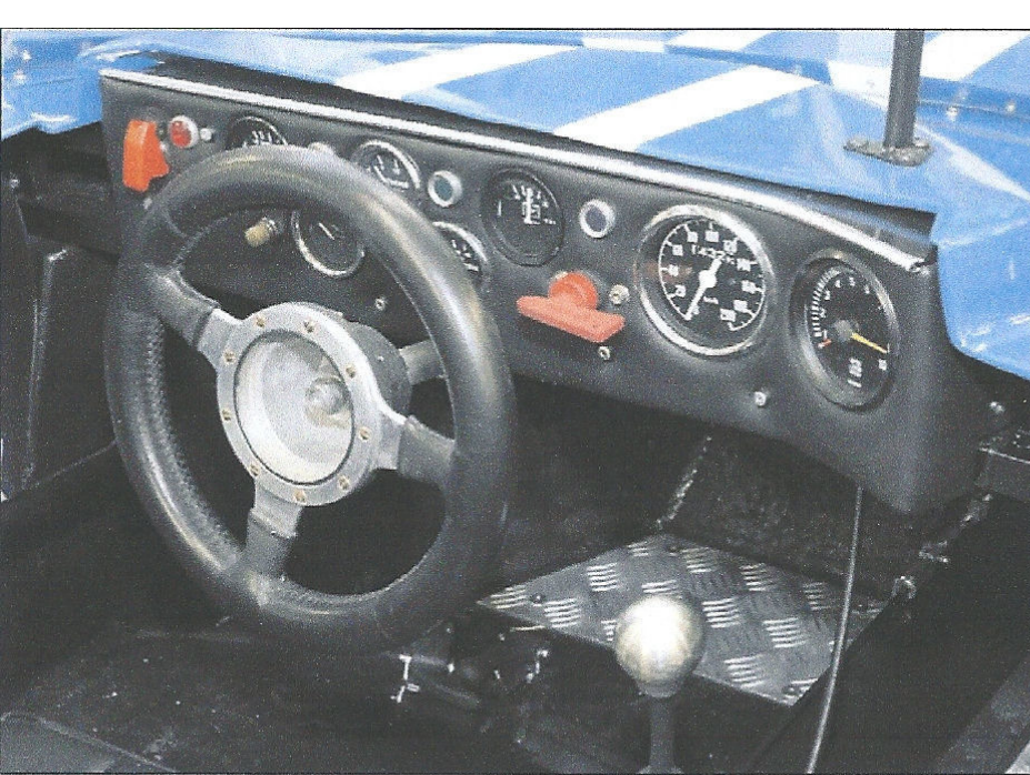
A bal oldali piros fedél alatt az önindító, jobbra az áramtalanító
