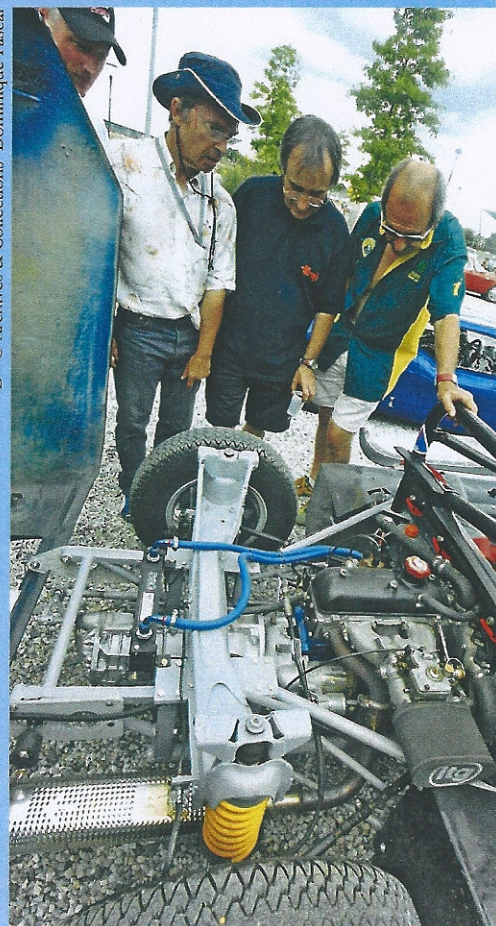
Sur cette photo sans le capot arrière, on comprend mieux l'astuce de la Marcadier. Le train arrière de la R 8 a été retourné, mettant ainsi le moteur entre l'essieu arrière et l'habitacle, en position centrale.
