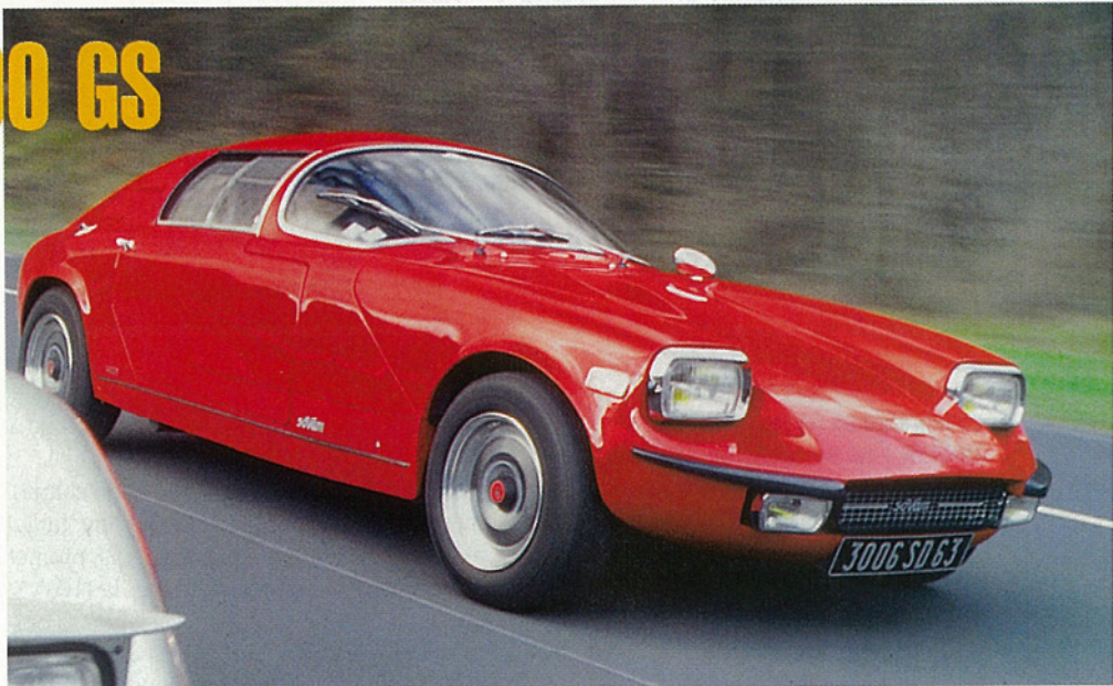
La Sovam présente l'originalité d'être une traction avant. Son moteur central lui offre en outre un parfait équilibre...
