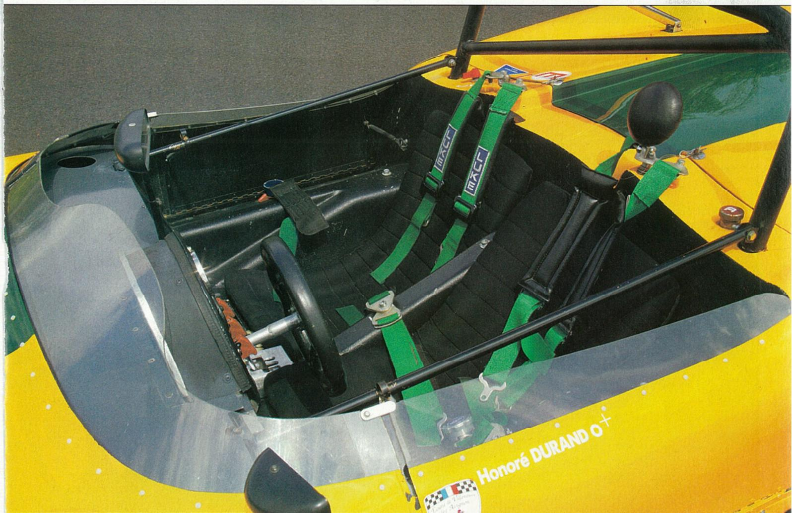
L'habitacle, biplace, avec à droite son réservoir de carburant homologué. On aperçoit les passages des tubes constituant le châssis. On note également l'arceau de sécurité et ses jambes de force arrières, qu'il faut démonter pour ouvrir le capot.
